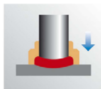
Der Bolzen taucht in das Schweißbad ein. Das Material erstarrt und der Bolzen ist fest aufgeschweißt.
